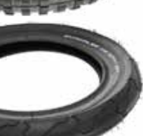
Schwalbe Big Apple Pneumatico con KevlarGuard Dimensioni: 300 x 50 mm (12 x 2.0") 350 x 50 mm (14 x 2.0")
